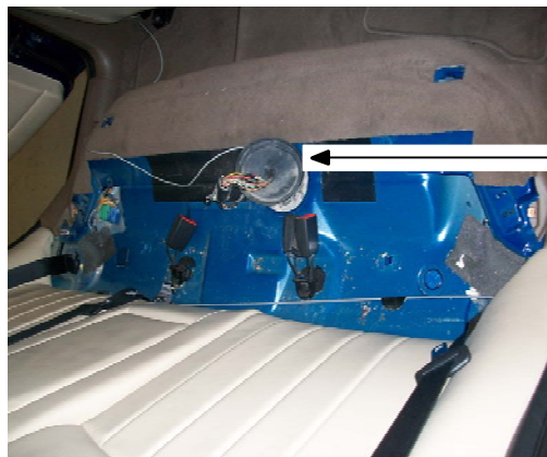
CONNETTORE POMPA BENZINA SITUATA SOTTO AL SEDILE POSTERIORE LATO PASSEGGERO
